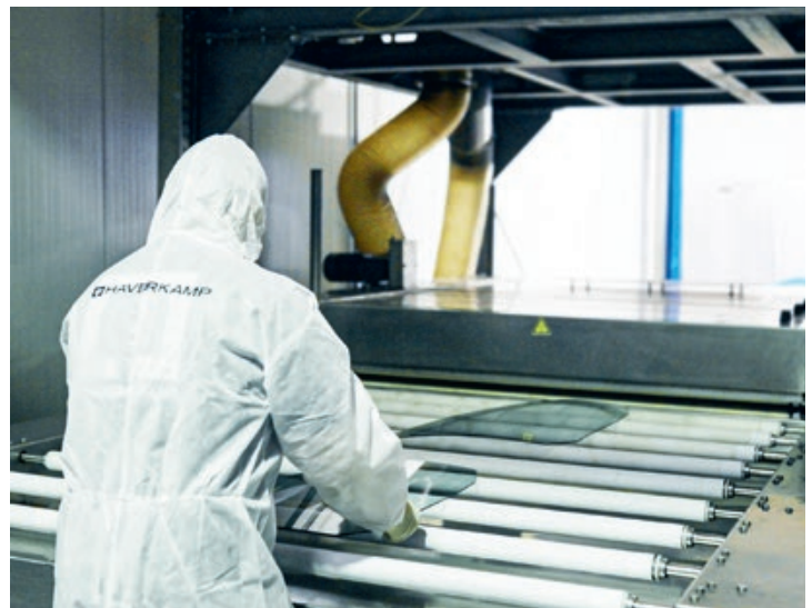
Produktion bei Haverkamp: In Münster werden die Funktionsfolien und variablen Systeme veredelt, weiterverarbeitet und mit modernster Technologie industriell auf Glas montiert
